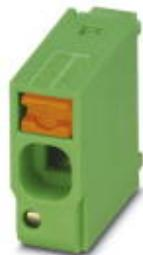
Клеммы для печатной платы, номинальный ток: 20 А, номинальное напряжение: 320 В, размер шага: 5 мм, полюсов: 1, тип подключения: Пружинные зажимы Push-in, монтаж: Пайка волной припоя, направление подключения, проводник/печатная плата: 0 °, цвет: зеленый
