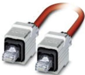
Кабель Sercos III, экранир., четверка звездной скрутки, AWG 22, гибкий (7-пров.), RAL 3020 (транспортный красный), на одном конце штекер RJ45 /IP67 с защелками, металл., на другом - штекер RJ45/IP67, металл., с мех. ключом D, длина: 5 м
