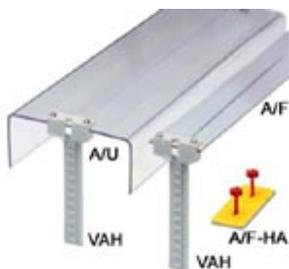
Плоская крышка, для закрытия клеммных колодок, толщина 2 мм, ширина 9 см, дополнительно требуется заказать 2 концевых держателя E/UK и 2 регулируемых держателя крышки VAH. Макс. длина 100 см.
