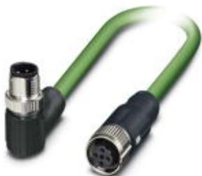
Сетевой кабель, PROFINET CAT5 (100 Мбит/с), 4-полюсн., PUR без галогенов, зеленый RAL 6018, экранирован., Штекеры угловой M12 SPEEDCON / IP67, механические ключи: D, к гнездо прямое M12 SPEEDCON / IP67, механические ключи: D, длина кабеля: 5 м
