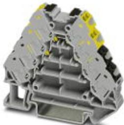
Распределитель потенциала, без нажимной кнопки, номинальное напряжение: 250 В, номинальный ток: 17,5 А, сечение: 0,14 мм<sup>2</sup> - 2,5 мм<sup>2</sup>, AWG: 14 - 26, тип подключения: Зажимы Push-in, полюсов: 2, количество подключений: 16, ширина: 8,3 мм, длина: 64 мм, цвет: серый, цвет элементов подключения: желтый, черный, монтаж: NS 35/7,5, NS 35/15
