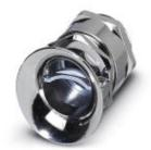
Металлический резьбовой крепежный элемент с приспособлением для защиты от зарегиба кабеля и снятия растягивающего усилия, длина резьбы: 8 мм, диапазон плотности кабеля: 18 - 27 мм, клеммный диапазон: 20 - 30 мм, SW 40, винтовое крепление: M32
