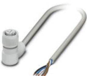
Кабель для датчика / исполнительного элемента, 5-полюсн., PP-EPDM без галогенов, серый RAL 7035, свободный конец, к Гнездо угловой M12, А-кодирование, с 3 светодиода, длина кабеля: 3 м, Гигиеничный дизайн, с пластмассовой накатанной гайкой
