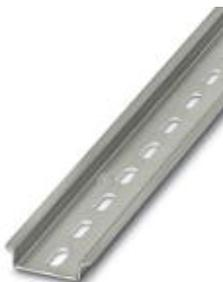
DIN-рейка, с перфорацией, Стандартный профиль, ширина: 35 мм, высота: 7,5 мм, согласно EN 60715, материал: Сталь, оцинкованный, длина: 2000 мм, Размер отверстия: 5,2 мм x 18 мм, цвет: серебристый
