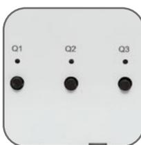
Механические кнопки управления выходными реле
