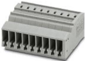
Соединитель COMBI, номинальное напряжение: 500 В, номинальный ток: 24 А, тип подключения: Пружинный зажим, количество точек подсоединения: 1, полюсов: 9, сечение: 0,08 мм<sup>2</sup> - 4 мм<sup>2</sup>, AWG: 28 - 12, ширина: 46,8 мм, высота: 21,8 мм, цвет: серый, тип монтажа: на монтажную пластину
