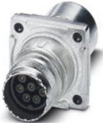
Проходная деталь, прямой, Крепление SPEEDCON, M17, полюсов: 7+PE, тип контактов: Розетка, Обжим, Плоское уплотнение, 4x Ø 3,2, экранирован.: есть, размер фланца: 25,75 мм x 25,75 мм, диапазон диаметра кабеля: 3,5 мм ... 5,5 мм
