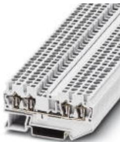
Проходные клеммы, номинальное напряжение: 800 В, номинальный ток: 24 А, тип подключения: Пружинный зажим, количество точек подсоединения: 4, сечение: 0,08 мм<sup>2</sup> - 4 мм<sup>2</sup>, AWG: 28 - 12, ширина: 5,2 мм, цвет: белый, тип монтажа: NS 35/7,5, NS 35/15
