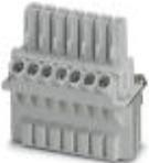
DUPLICON, контактная вставка соединителя, 6 x 4 мм<sup>2</sup> + PE, 400/690 В, 25 А, резьбовое соединение, тип B6, степень защиты IP20
