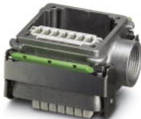
Duplicon, комплект алюминиевого штекера этажерочного типа в этажерочном корпусе с резьбовым вводом M20 (без кабельного сальника) и контактной вставкой 6 x 4 mm<sup>2</sup> + PE, 400/690 В, 25 A, резьбовые зажимы, типоразмер B6, степень защиты IP67
