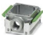
DUPLICON, алюминиевый этажерочный корпус для контактных вставок DUPLICON, тип B6, степень защиты IP67, с двумя защелками, уплотнением и одним резьбовым кабельным вводом M20 (без кабельного сальника)
