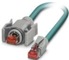
Готовый Ethernet-кабель, CAT6, экранированный, 4 пары, гибкий AWG 26 (7-проволочный), RAL 5021 (цвет морской воды), разъемы RJ45/IP67, серый, и RJ45/IP20, прямая разводка, длина 6,5 м
