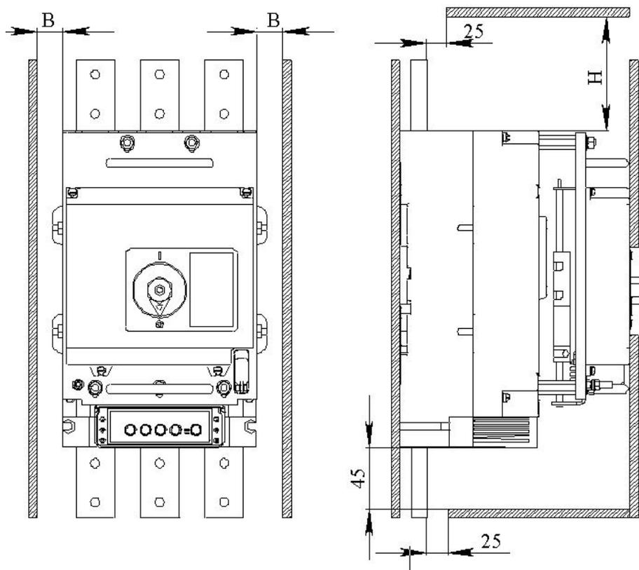
**Рисунок Д.2** – Автоматический выключатель с электромагнитным приводом.
