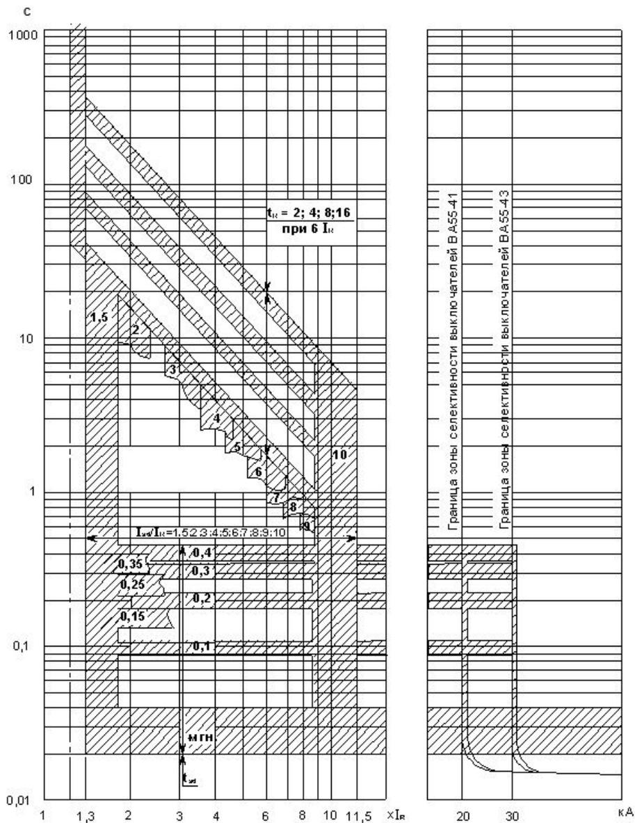
**Рисунок В.3** – Выключатель ВА55-41. Обрато-квадратичная зависимость
