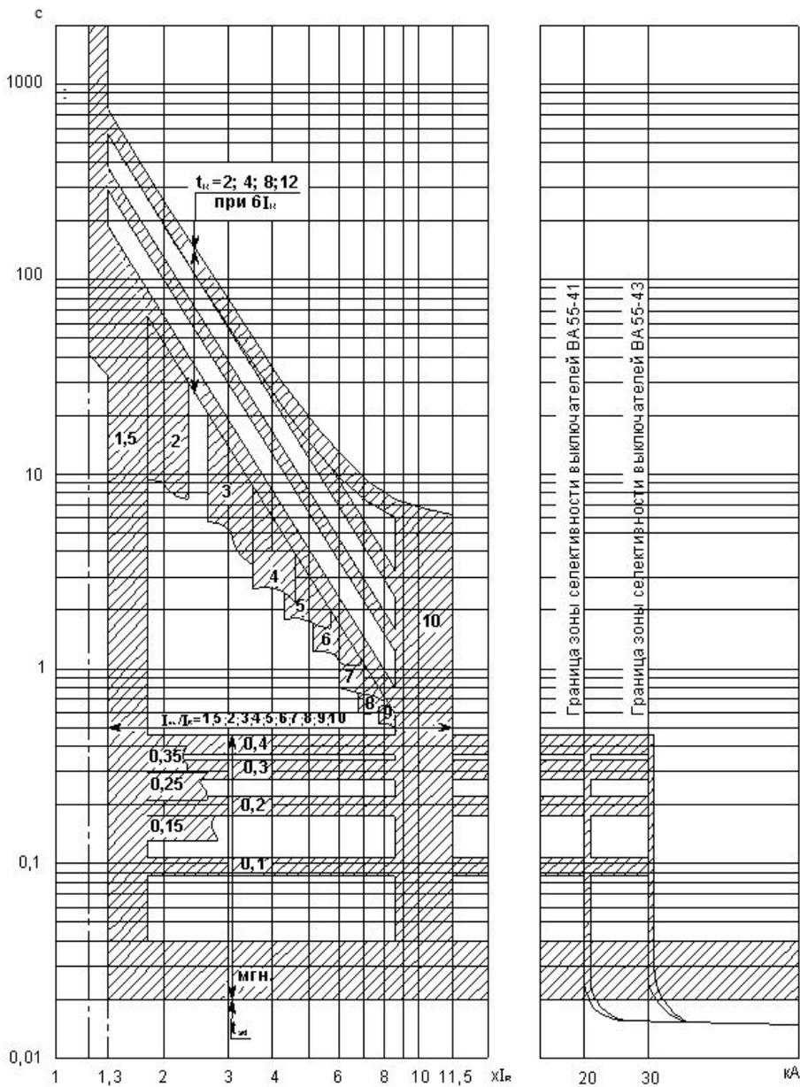
**Рисунок В.4** – Выключатель ВА55-41. Обрато-кубическая зависимость
