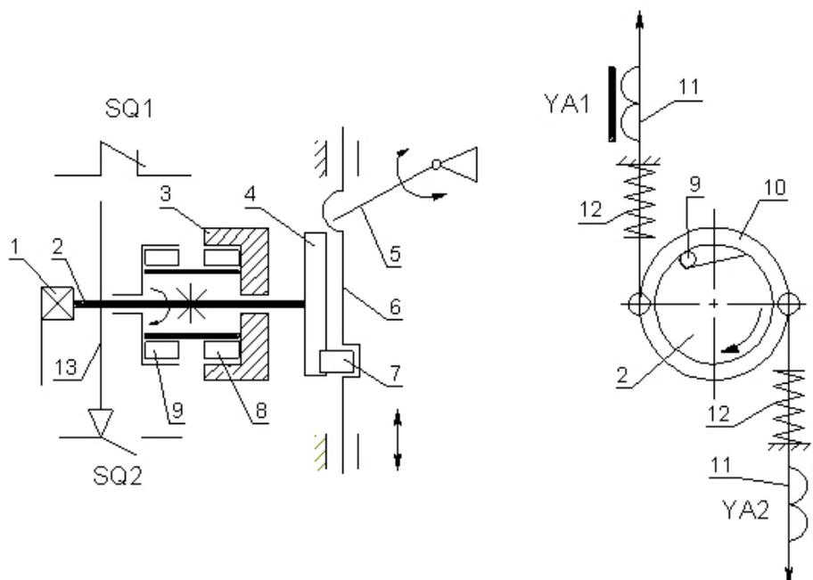
**Рисунок 6** – Кинематическая схема электромагнитного привода.
