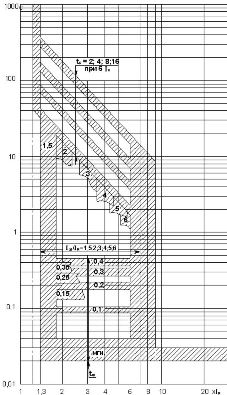
**Рисунок В.1** – Выключатель ВА53-41. Обратная-квадратичная зависимость
