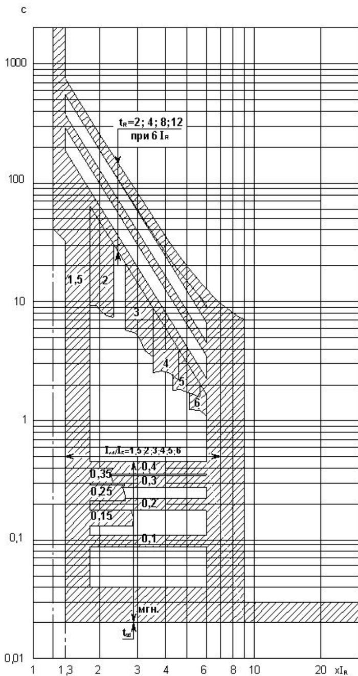
**Рисунок В.2** – Выключатель ВА53-41. Обрато-кубическая зависимость
