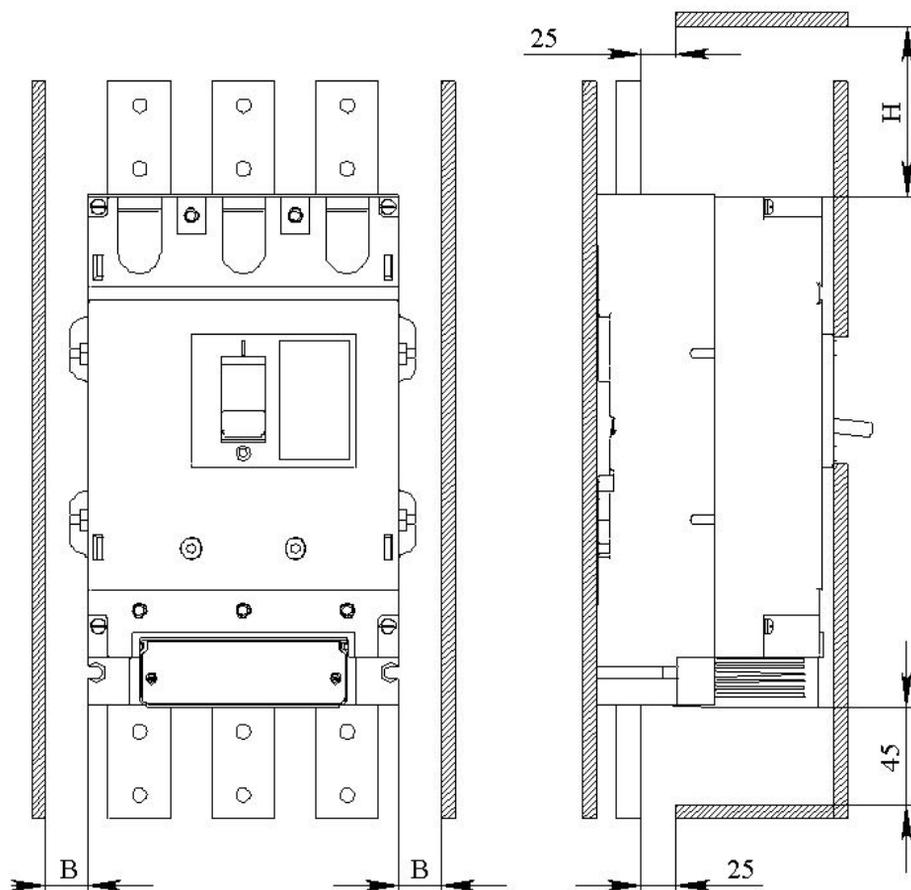
**Рисунок Д.1** – Автоматический выключатель с ручным приводом
