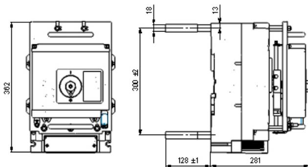
**Рисунок Б.4** – Автоматический выключатель с электромагнитным приводом (заднее присоединение)
