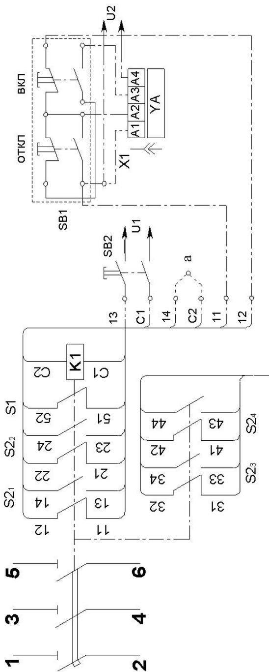
**Рисунок Г.2** – Автоматический выключатель с дополнительными сборочными единицами.
