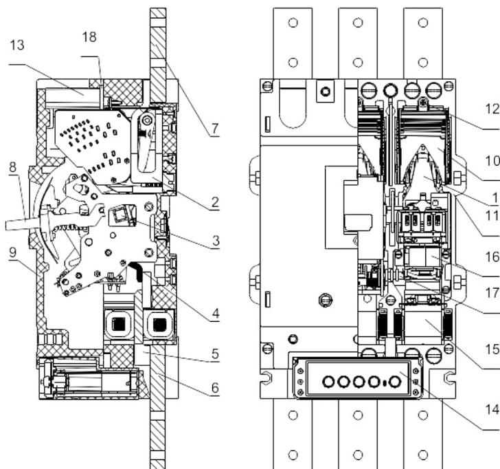
**Рисунок 1** – Автоматический выключатель ВА55-41 стационарного исполнения
