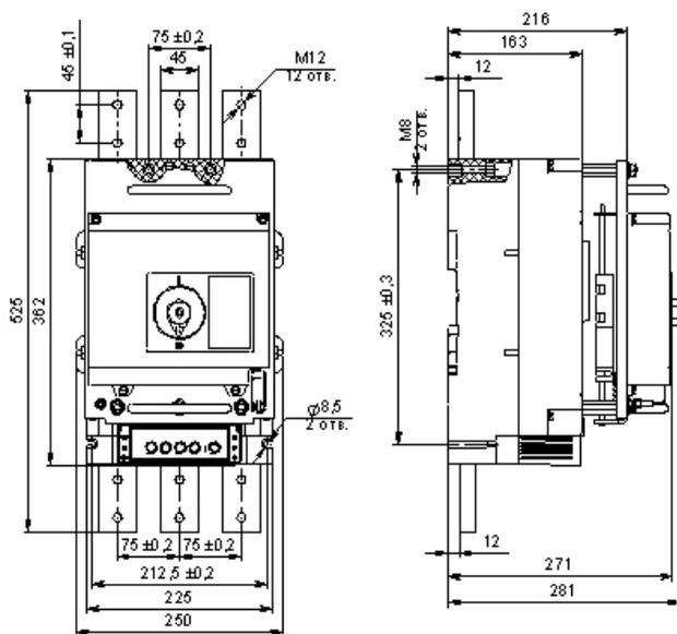
**Рисунок Б.2** – Автоматический выключатель с электромагнитным приводом (переднее присоединение)
