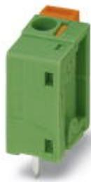
Клеммы для печатной платы, номинальный ток: 17,5 А, номинальное напряжение: 630 В, размер шага: 7,62 мм, полюсов: 1, тип подключения: Пружинные зажимы Push-in, монтаж: Пайка волной припоя, направление подключения, проводник/печатная плата: 90°, цвет: зеленый. Конечная клемма для терминирования индивидуально подобранных блоков.
