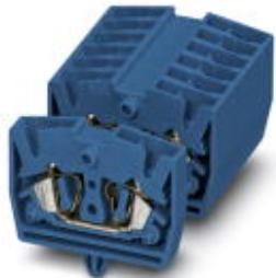
Проходная мини-клемма, номинальное напряжение: 800 В, номинальный ток: 24 А, тип подключения: Пружинный зажим, количество точек подсоединения: 2, сечение: 0,08 мм<sup>2</sup> - 4 мм<sup>2</sup>, AWG: 28 - 12, ширина: 5,2 мм, высота: 22 мм, цвет: синий, тип монтажа: на монтажную пластину
