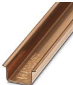
Несущая рейка без перфорации, Стандартный профиль, ширина: 35 мм, высота: 15 мм, соотв. EN 60715, материал: Медь, без покрытия, длина: 2000 мм, цвет: Под медь
