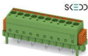
Разъем для установки прямо на печатную плату, номинальный ток: 12 A, расчетное напряжение (III/2): 320 В, полюсов: 9, размер шага: 5 мм, тип подключения: Пружинные зажимы Push-in, цвет: зеленый, поверхность контакта: олово, монтаж: SKEDD - Непосредственное подсоединение
