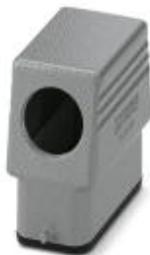
Сальниковый корпус HEAVYCON, D15, для продольной защелки, высота 66 мм, без опоры 1x M25, боковое подключение кабеля
