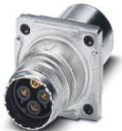
Проходная деталь, прямой, Крепление SPEEDCON, M17, полюсов: 3+PE, тип контактов: Розетка, Обжим, Плоское уплотнение, 4x Ø 3,2, экранирован.: есть, размер фланца: 25,75 мм x 25,75 мм, диапазон диаметра кабеля: 3,5 мм ... 5,5 мм
