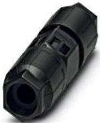
Кабельный соединитель, Тип подключения QUICKON, полюсов: 3+PE, 0,5 мм<sup>2</sup> ... 1,5 мм<sup>2</sup>, 690 В, 17,5 А, черный, с двумя гайками QUICKON, диапазон диаметра кабеля: 10 мм ... 13 мм
