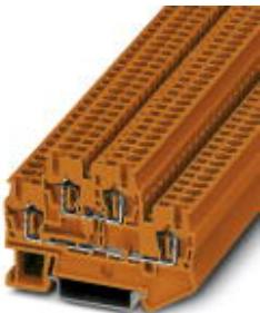
Двухъярусная пружинная клемма, тип подключения: Пружинный зажим, сечение: 0,08 мм<sup>2</sup> - 4 мм<sup>2</sup>, AWG: 28 - 12, ширина: 5,2 мм, цвет: оранжевый, тип монтажа: NS 35/7,5, NS 35/15
