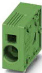
Клеммы для печатной платы, номинальный ток: 41 А, номинальное напряжение: 1000 В, размер шага: 7,5 мм, полюсов: 2, тип подключения: Пружинные зажимы Push-in, монтаж: Пайка волной припоя, направление подключения, проводник/печатная плата: 0 °, цвет: зеленый
