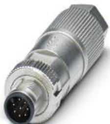
Соединитель для датчика/исполнительного устройства, 8-полюсн., без галогенов, экранирован., Штекеры прямое M12 SPEEDCON, А-кодирование, Клеммы с ножевыми контактами, материал накатанной гайки: Цинк. литья под давлением, с никелевым покрытием, наружный диаметр кабеля 5 мм ... 9,7 мм
