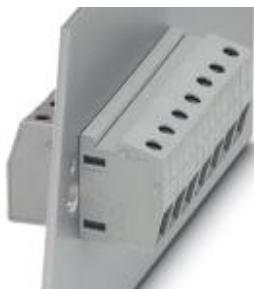
Проходная клемма, тип подключения: Винтовые зажимы, полюсов: 1, ток нагрузки: 76 A, сечение: 0,5 mm<sup>2</sup> - 16 mm<sup>2</sup>, AWG 20 - 6, угол между направлениями подключения провода и установки разъема: 0 °, ширина: 10,1 мм, цвет: серый
