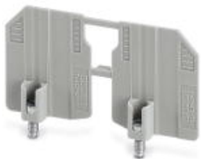
Фланцевая крышка, установка на штекеры UP 4/..., длина: 47 мм, ширина: 4,5 мм, высота: 24,7 мм, цвет: серый
