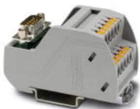
Модуль VARIOFACE с зажимами Push-in и штыревым мини-разъемом D-SUB, для установки на монтажные рейки NS 35, число полюсов: 9
