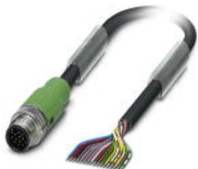
Кабель для датчика / исполнительного элемента, 17-полюсн., ПВХ, черный RAL 9005, Штекеры прямое M12 SPEEDCON, А-кодирование, к свободный конец, длина кабеля: 10 м
