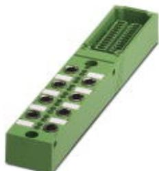
Корпус коробки датчика и исполнительного элемента, применение: Стандартн., тип подключения: Розетка M8 металл, количество гнезд: 8, полюсов: 3, механические ключи: A - стандарт, гнездо для платы: один ряд, индикатор состояния: есть, р-п-р; подключение магистрального кабеля: вставные винтовые клеммы, экранировка: нет
