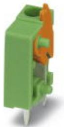
Клеммы для печатной платы, номинальный ток: 15 А, номинальное напряжение: 320 В, размер шага: 5,08 мм, полюсов: 1, тип подключения: Пружинные зажимы Push-in, монтаж: Пайка волной припоя, направление подключения, проводник/печатная плата: 90°, цвет: черный
