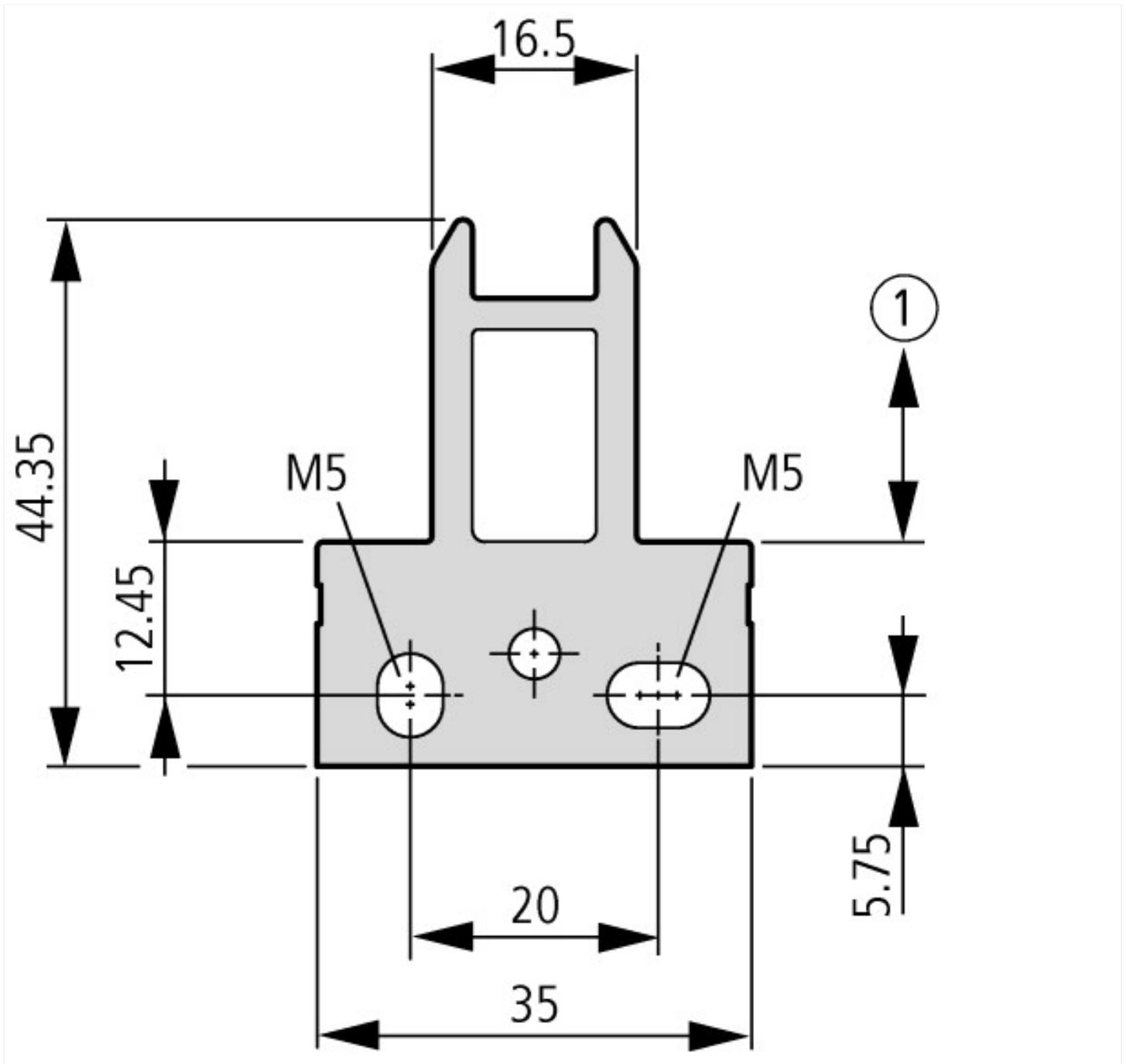
① Расстояние до головки устройства = 0,1 ... 3,0 мм
