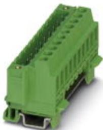
Штекер для установки на монтажную рейку, номинальный ток: 12 A, расчетное напряжение (III/2): 320 В, полюсов: 9, размер шага: 5,08 мм, тип подключения: Винтовой зажим с натяжной гильзой, цвет: зеленый, поверхность контакта: олово, монтаж: Монтажная рейка
