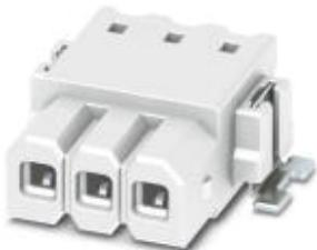
Корпусная часть для печатных плат, номинальный ток: 6 A, расчетное напряжение (III/2): 160 В, полюсов: 3, размер шага: 2,5 мм, цвет: белый, поверхность контакта: олово, монтаж: SMD пайка
