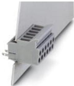
Проходная клемма, тип подключения: Винтовые зажимы, Контакты под пайку / разъем для подключения плоского штекера, полюсов: 1, сечение: 0,2 мм<sup>2</sup> - 4 мм<sup>2</sup>, AWG 24 - 12, ширина: 6,1 мм, цвет: серый
