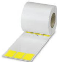
Маркер для кабелей, рулон, желтый, без маркировки, маркируется с помощью: THERMOMARK ROLLMASTER 300/600, THERMOMARK X1.2, THERMOMARK ROLL X1, THERMOMARK ROLL 2.0, THERMOMARK ROLL, тип монтажа: склеивание, диаметр кабеля: ≤ 36 мм, размер маркировочного поля: 25 x 38 мм
