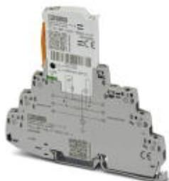
Устройство защиты от перенапряжений (защитный штекер и базовый элемент), со встроенным индикатором состояния для одной 2-проводной сигнальной цепи без потенциала земли. Непрямое заземление через газовый разрядник.
