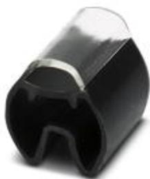
Держатель маркировки проводника, прозрачный/черный, без маркировки, вид монтажа: насаживание, диаметр кабеля: 4 - 7 мм, размер поля для маркировки: 4 x 10 мм
