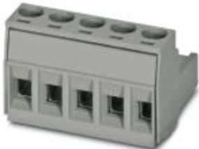
Разъемы для печатной платы, номинальный ток: 12 A, расчетное напряжение (III/2): 320 В, полюсов: 10, размер шага: 5 мм, тип подключения: Винтовой зажим с натяжной гильзой, цвет: сигнальный серый, поверхность контакта: олово
