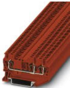
Проходные клеммы, номинальное напряжение: 500 В, номинальный ток: 17,5 А, тип подключения: Пружинный зажим, количество точек подсоединения: 3, сечение: 0,08 мм<sup>2</sup> - 1,5 мм<sup>2</sup>, AWG: 28 - 16, ширина: 4,2 мм, цвет: красный, тип монтажа: NS 35/7,5, NS 35/15
