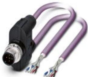
Системный кабель шины, CANopen®, DeviceNet™, 5-полюсн., PUR без галогенов, фиолетовый RAL 4001, экранирован., Штекеры прямое M12 SPEEDCON, А-кодирование, к свободный конец и свободный конец, длина кабеля: 2 м, Соединитель неэкранированный, Экран подсоединен к выводу 1
