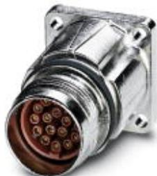
Аппаратн. соединитель, передняя стенка, прямой, для стандартной блокировки и SPEEDCON, M17, полюсов: 17, тип контактов: Розетка, Обжим, экранирован.: есть, размер фланца: 21,6 мм x 21,6 мм
