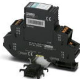
Устройство защиты от перенапряжений, состоит из штекерного модуля и базового элемента, со встроенной многоступенчатой индикацией состояния на модуле, для защиты сдвоенных проводников аналоговых и цифровых телекоммуникационных интерфейсов (VDSL до 50 Мбит/с, на коротких дистанциях (< 300м) до 100 Мбит/с).
