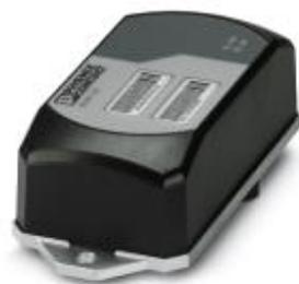
Точка доступа WLAN, клиент с двумя внутренними антеннами (MIMO) для монтажа в отверстие, IP54, WLAN 802.11 a, b, g, n, частота: 2,4 ГГц, 5 ГГц (вкл. каналы DFS), разъемы: COMBICON 9 ... 32 В DC, RJ45: для LAN, веб, http/https, интерфейс командной строки
