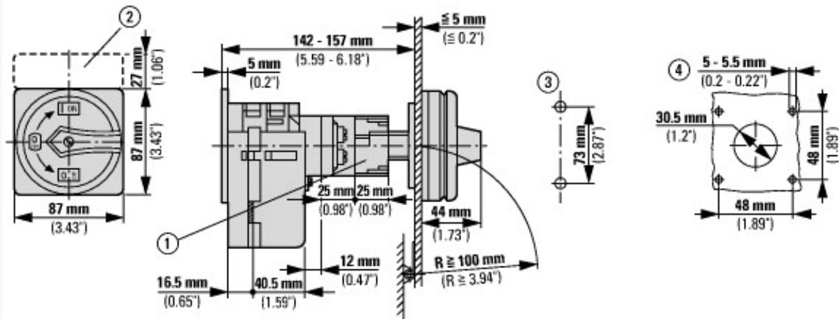
① Возможны удлинение вала и дополнительная взаимная блокировка с ZAV-P3 + ZVV-P3, макс. 4 x 25 = 100 мм
