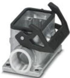
Приборный корпус B6, с одной защелкой, материал: Из алюминия, методом литья под давлением, стойкий к морской воде, длина кабеля: 2, боковое, высота: 54,6 мм, кабельный ввод: без, патрубок: Нет, 2x Pg16, Стандартн.
