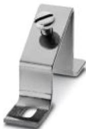
Угловой зажим с винтами М6, закрепляет монтажную рейку в наклонном положении (под углом 30°), высота: 46 мм
