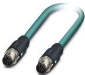
Сетевой кабель, Ethernet CAT5 (1 Гбит/с), 8-полюсн., PUR, цвет морской воды RAL 5021, экранирован., Штекеры прямое M12 SPEEDCON / IP67, механические ключи: A, к Штекеры прямое M12 SPEEDCON / IP67, механические ключи: A, длина кабеля: 5 м
