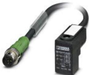
Кабель для датчика / исполнительного элемента, 3-полюсн., PUR без галогенов, темно-серый RAL 7021, Штекеры прямое M12, A-кодирование, к Штекер типа C для электромагнитного клапана (8 мм), с 1 светодиод, подключение с помощью Диод Зенера, подключение с помощью Диод Зенера, длина кабеля: 1,5 м
