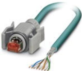
Готовый Ethernet-кабель, экранир., 4 пары, AWG 26, гибкий (7-жильный), RAL 5021 (цвет морской воды), штекер RJ45/IP67, серый, второй конец - без разъема, прямая разводка, длина 5 м
